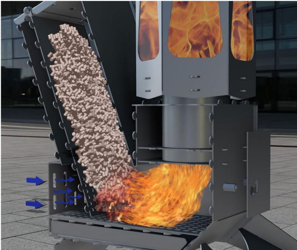
Das Rauchrohr erzeugt durch das aufsteigen der heißen Abgase den nötigen Unterdruck der die Funktion des Terrassenofens ermöglicht. Die Holzpellets werden durch den Luftzug angefacht und erzeugen das zur Verbrennung benötigte Holzgas. Der verbrannte Brennstoff (Asche) fällt in die Aschenschublade. Durch das schwinden des Brennstoffs rutscht das Brennmaterial nach und der Prozesskreislauf läuft weiter.
