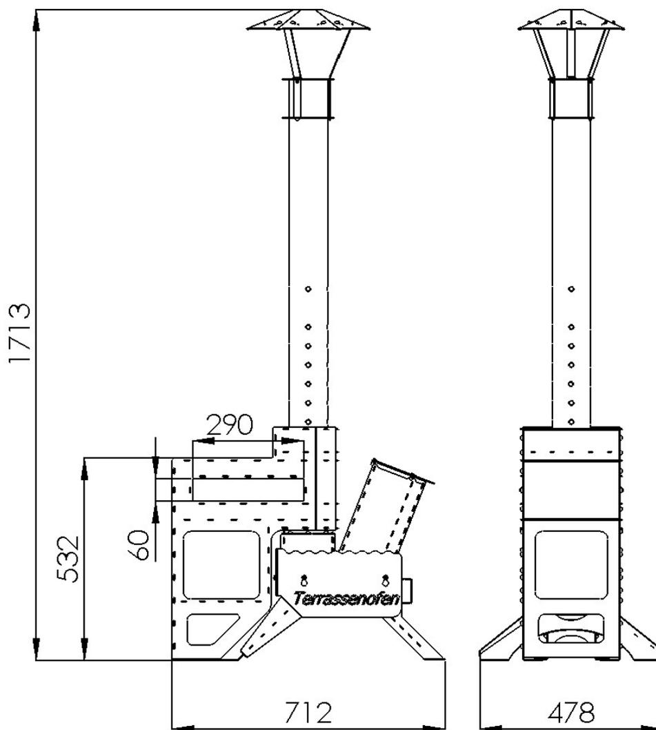
**Abmessungen:** 712mm x 478mm x 1713mm
