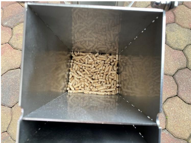
Nun füllen Sie Pellets in den Brennstoffbehälter. Wichtig ist das der Tank viertel gefüllt ist. Damit der Luftzug die Pellets anfachen kann. Das kann man am Brenngeräusch erkennen ob der Terrassenofen richtig zieht.
