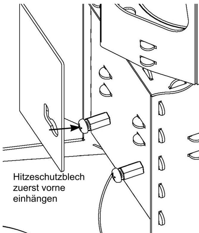
Hängen Sie das Hitzeschutzblech zuerst vorne ein danach das Hitzeschutzblech nach hinten schieben und anschließend in den hinteren Schrauben einhängen.
