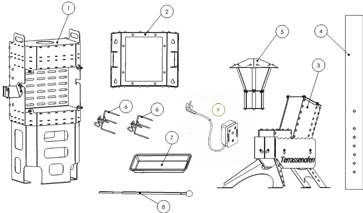
Pos. 1 1x elektrischer Drehgrill Type-5 Grundmodul
