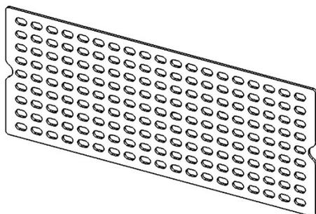
Der Rost des Terrassenofen ist für mehrere Jahre Lebensdauer ausgelegt. Eine Verformung des Rostes ist völlig normal. Der Niro Edelstahl verformt sich unter Hitzeeinfluss.
